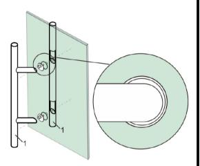
Installez les vis de réglage et serrez avec la clé Allen pour terminer l'installation
