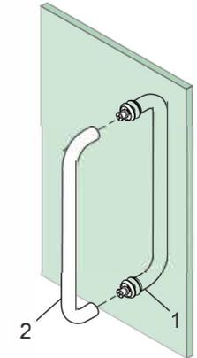
Installez les vis de réglage et serrez avec la clé Allen pour terminer l'installation.
